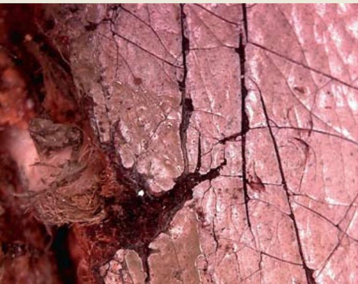
**Knickbeschädigung.** Ledertapete bei 200facher Vergrößerung. Die Bruchlinien im Randbereich verlaufen überwiegend parallel zu den Leisten des Spannr Rahmens an der klar vordefinierten Knicklinie am linken Bildrand.
